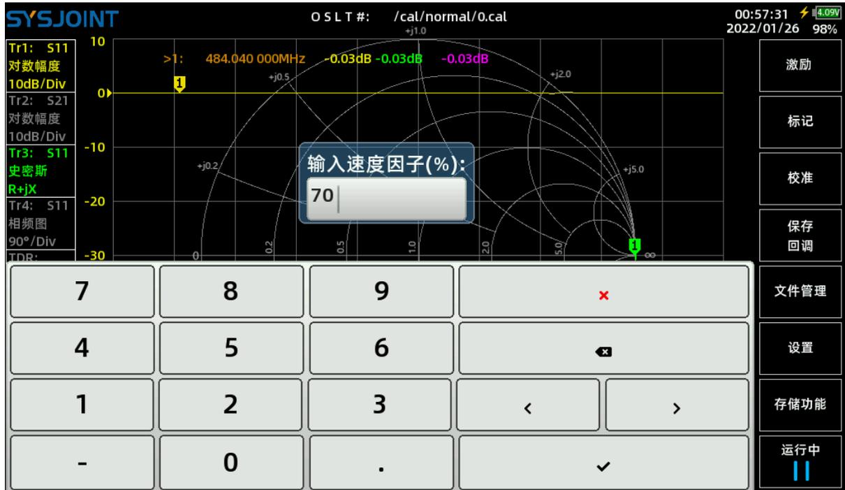
注意，测量电缆长度时，设置的频率越高则可测量的电缆最大长度越短；设置的频率越低则可测量的电缆最大长度越长，因此需要根据实际情况设置合适的频率范围。
