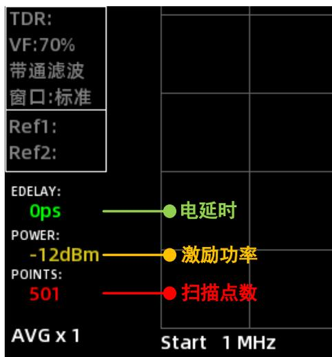
图 3 快速设置电延时、激励功率、扫描点数
